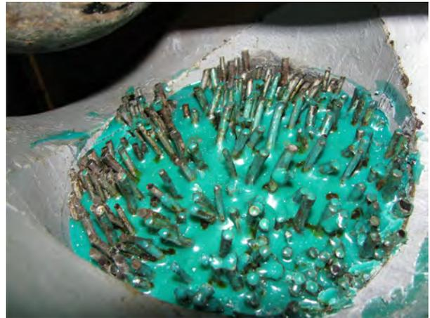
Afin d'éliminer ou de minimiser le risque de fissures superficielles, veillez à terminer la coulée de la résine dans la douille jusqu'à ce qu'elle atteigne juste l'extrémité des fils et au niveau ou légèrement en dessous du raz du bol du culot. Vouloir obtenir une surface lisse en surface pour donner une meilleure apparence n'est pas souhaitable car ceci risque d'être refusé par le client en raison de la présence d'une fissure à l'issue des tests d'épreuve.
